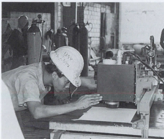
日本製投映型切断機を操作する小工場の労働者。
